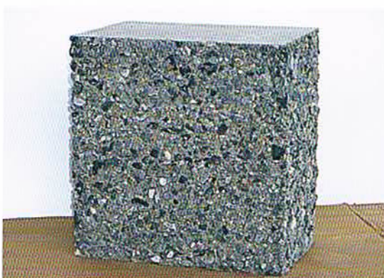
土木：打ち継ぎ面処理
