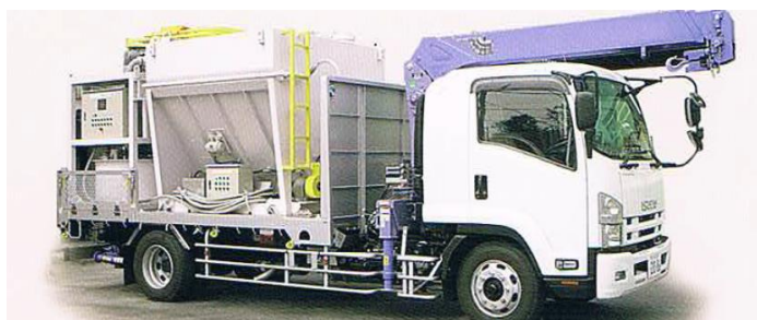
車載フラントと橋脚鋼板巻き立て工事への適用
